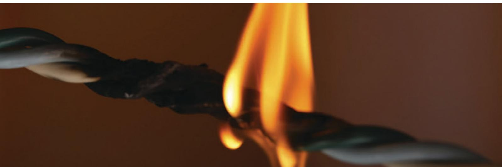
NFPA 262: 空氣處理空間所用電線電纜火焰傳播和煙霧測試的標準方法
