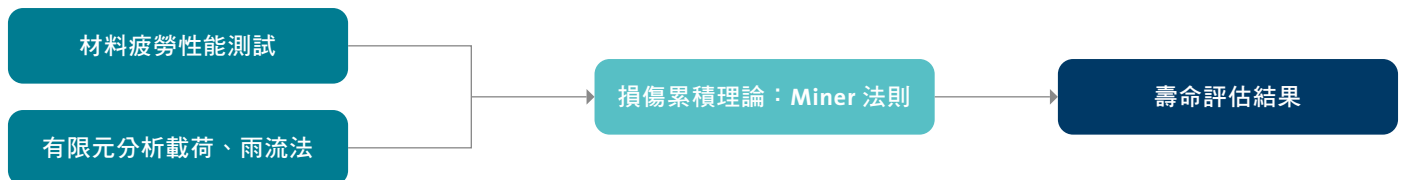
〈圖二〉以結合有限元計算與試驗方法進行壽命評估
