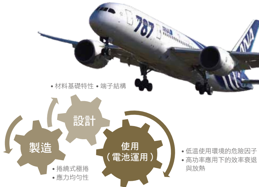
《圖一》UL 針對波音 787 鋰電池失效事故之因的調查快速示意
