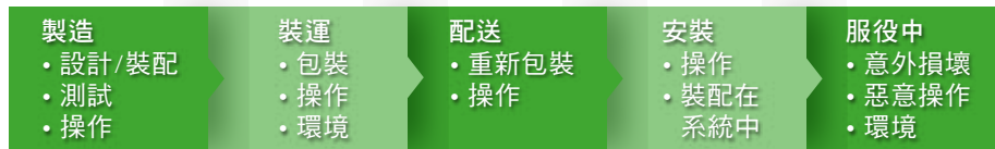
《圖二》玻璃球感溫組件損壞的潛因及灑水頭意外噴水原因
